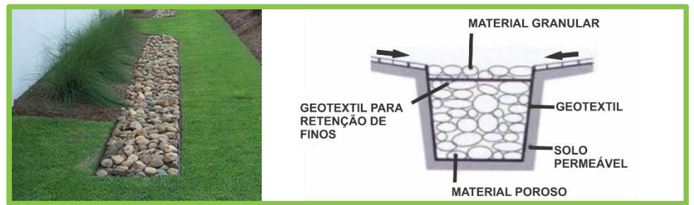
Figura 8.4. Ações de drenagem sustentável no meio urbano.
