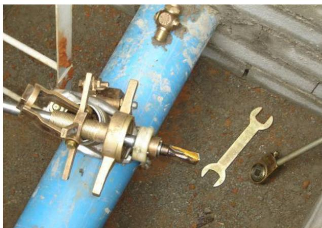
Figura 3.9. Broca encaixada na base da máquina
