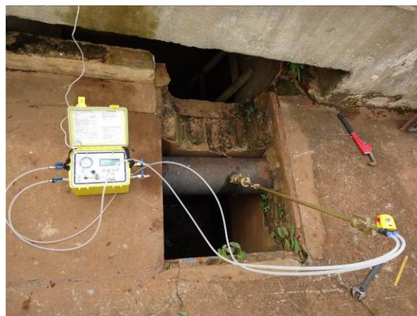
Figura 1.14. Vista do Pitot, mangueiras e sensor diferencial de pressão
