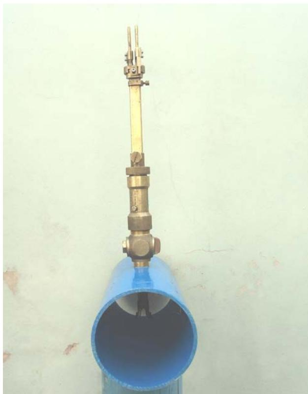
Figura 1.13. Vista de um Pitot dentro da tubulação
