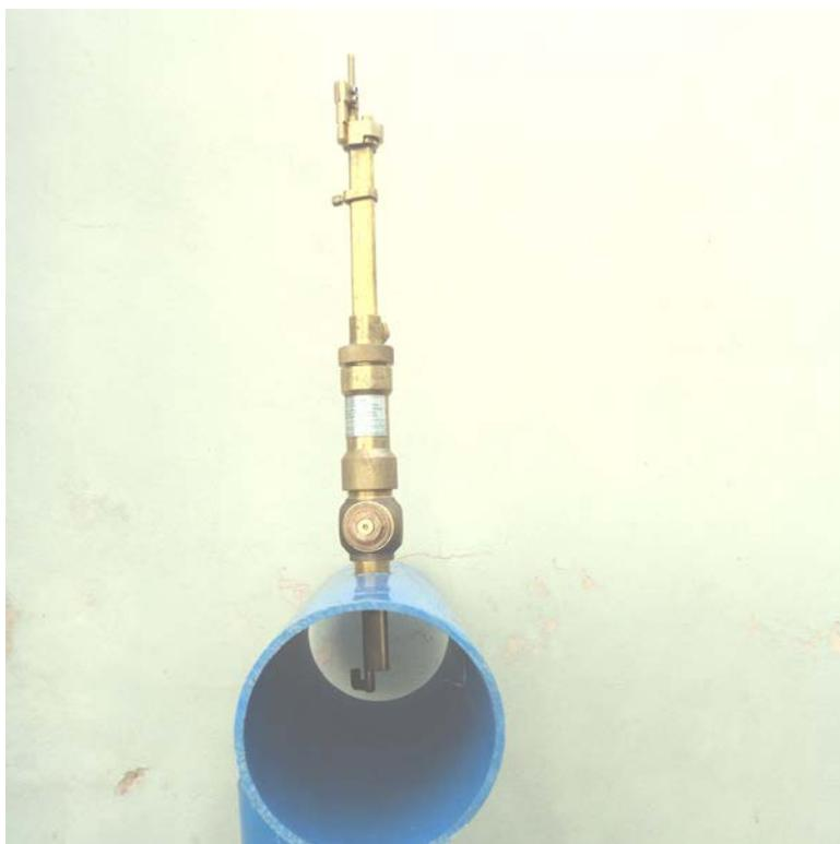
Figura 1.12. Vista do Calibre em uma tubulação
