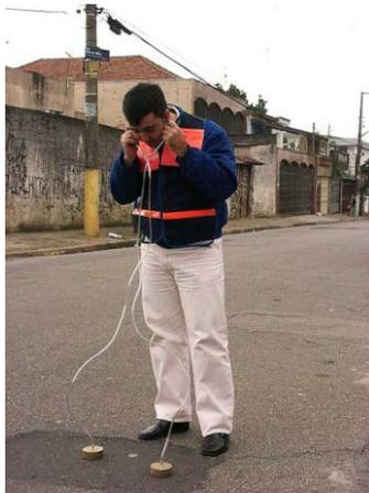
Figura 8.11. Vista do Geofone Mecânico
