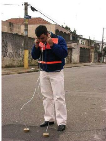
Figura 1.20. Vista do Geofone Mecânico
