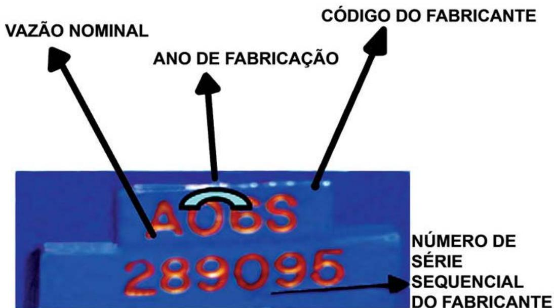
Figura 10.28. Numeração do hidrômetro
