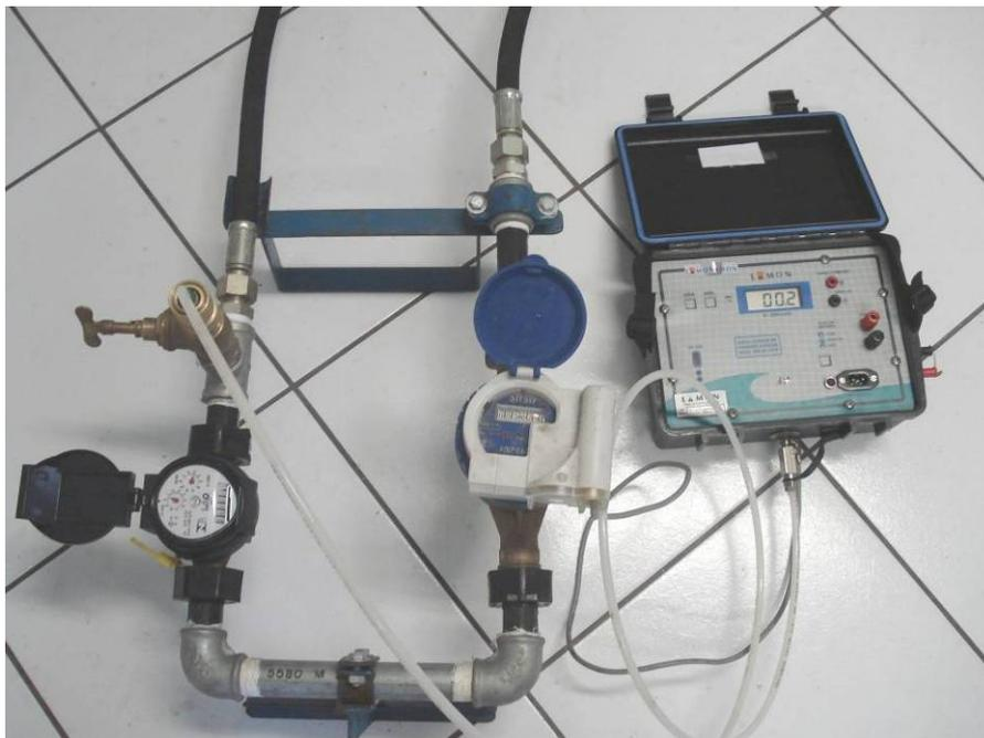
Figura 7.1. Equipamento data-logger de pressão que será utilizado para medir pressão no sistema de abastecimento do município de Rafard
