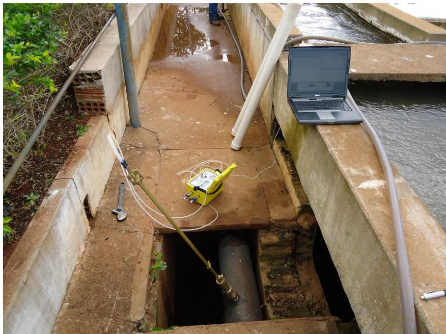
Figura 1.6. Vista durante uma medição através da pitometria
