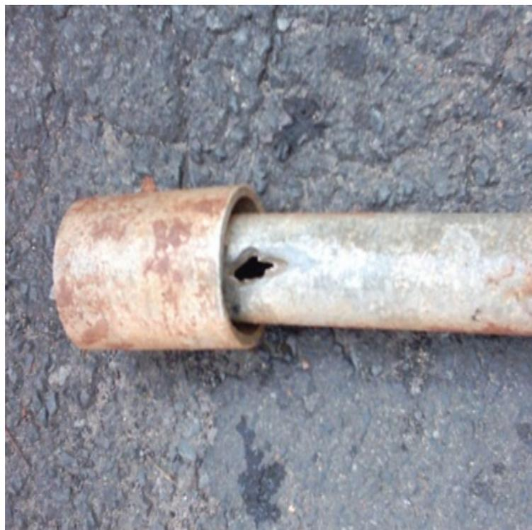
Figura 8.4. Furo na rede que causou o vazamento
