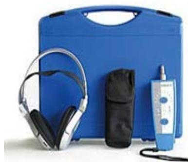
Figura 1.23. Vista da haste de escuta eletrônica
