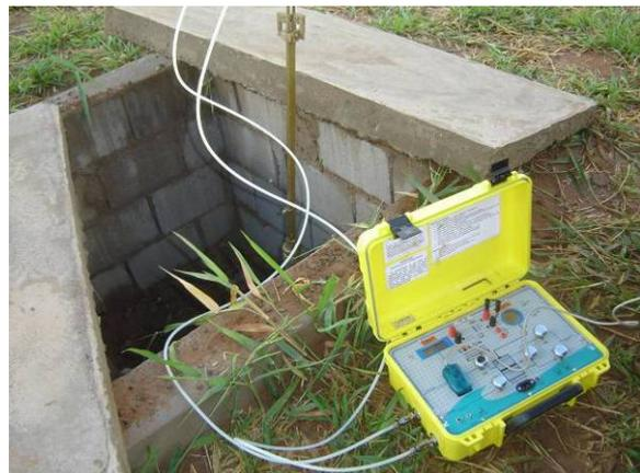
Figura 3.21. Tubo Pitot inserido em uma tubulação e conectado a um equipamento que contém um sensor de diferencial de pressão
