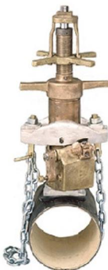
Figura 3.11. Máquina Miller instalada em uma tubulação
