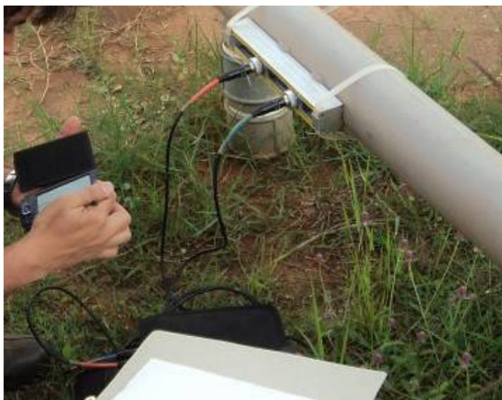
Figura 1.2. Ilustração da comunicação entre o Palm e Unidade Eletrônica
