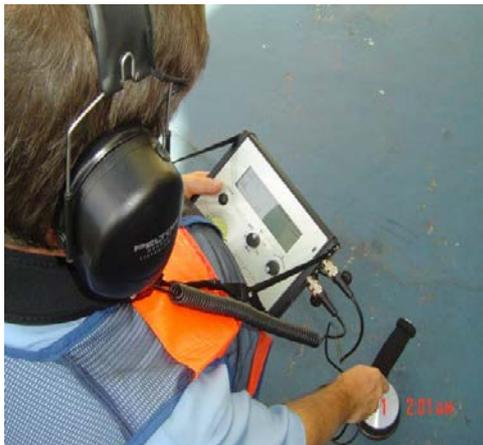
Figura 1.18. Vista do Geofone Eletrônico
