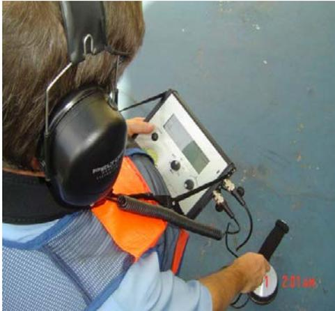
Figura 8.9. Vista do Geofone Eletrônico
