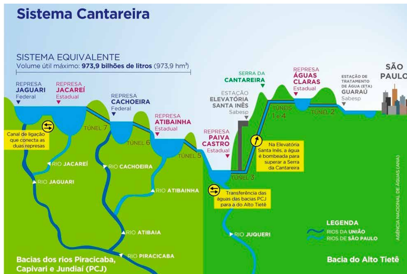
Figura 5: Fluxograma simplificado do Sistema Cantareira. Fonte: (ANA, 2015).
