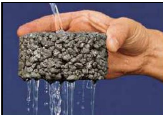
Figura 15 - Dispositivo de Controle de escoamento – Pavimento Poroso
