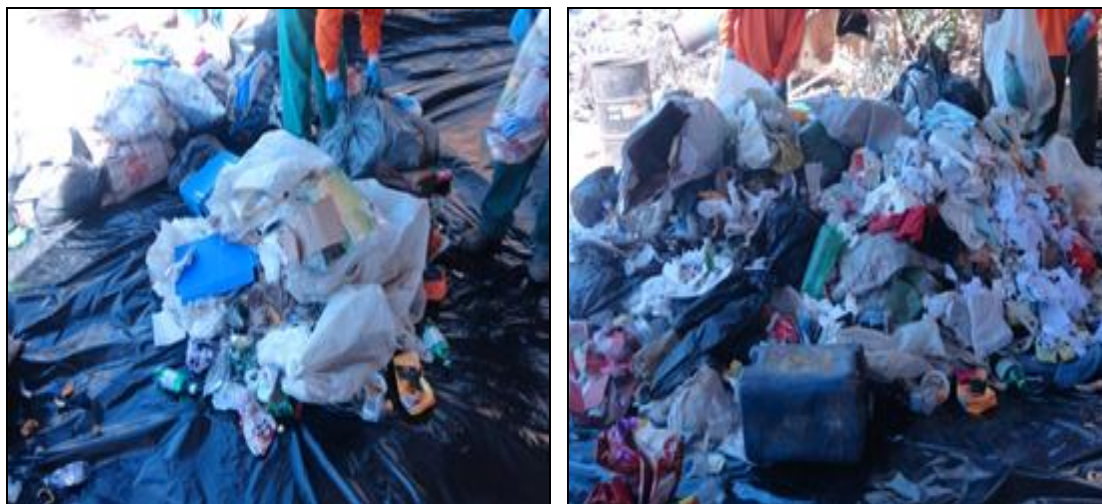
Figura 116 - Disposição dos resíduos sobre a lona e retirada dos sacos e sacolas.
