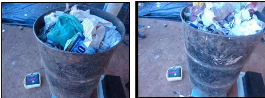
Figura 121 - Tambores com resíduos da amostra final sendo transportados até a balança e pesados
