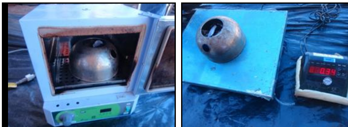
Figura 124 - Retirada da amostra de 2L da estufa e pesagem da mesma
