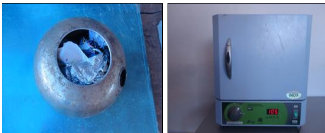
Figura 120 - Amostra de 2L de resíduos sendo pesada e posteriormente já inserida em estufa a 105°C.
