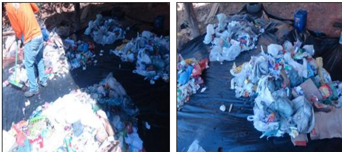
Figura 118 - Quarteamento e armazenamento da amostra final resultante de cada caminhão.
