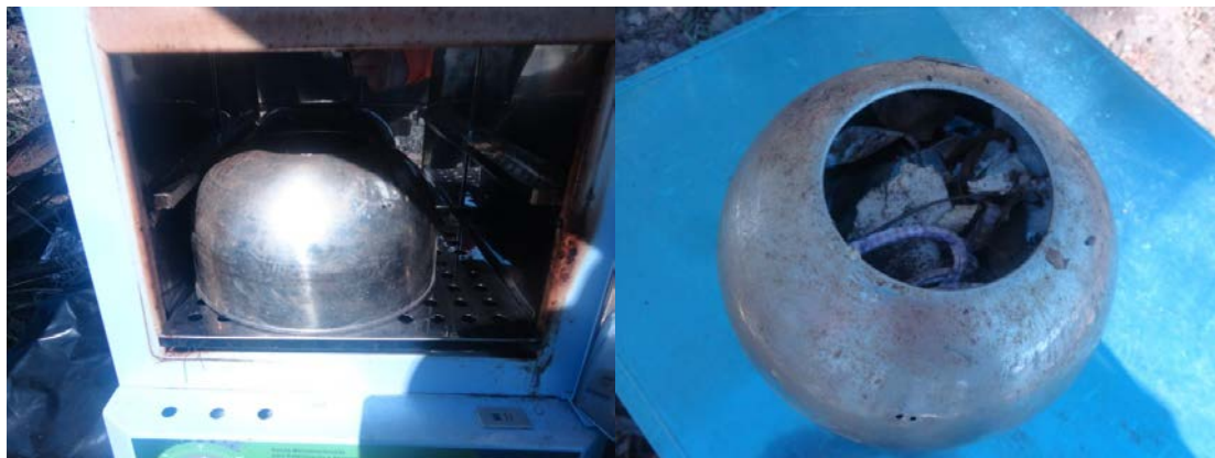
Figura 12 - Retirada do recipiente de 2 L da estufa e pesagem para determinação do teor de umidade.
