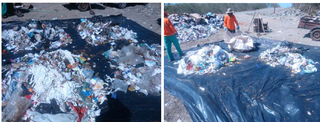
Figura 7 – Quarteamento, seleção e armazenamento de amostragem homogeneizada.
