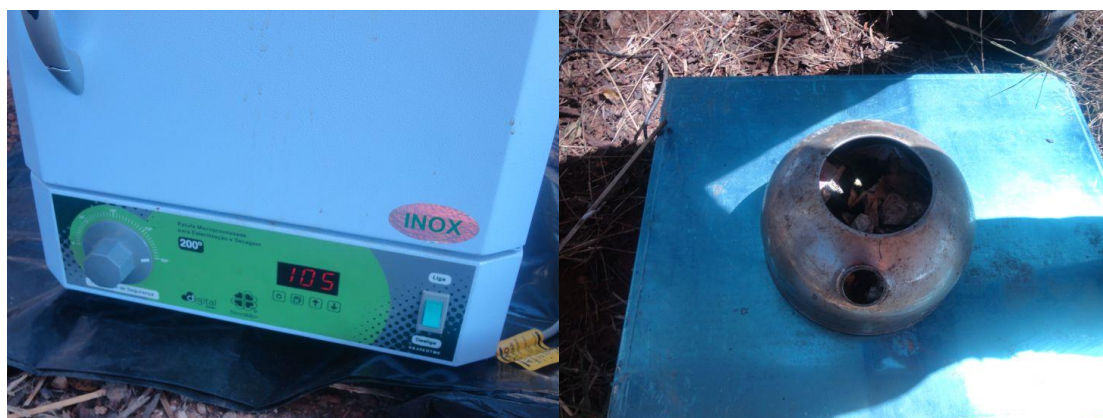
Figura 13 - Retirada do recipiente de 2 L da estufa e pesagem para determinação do teor de umidade.
