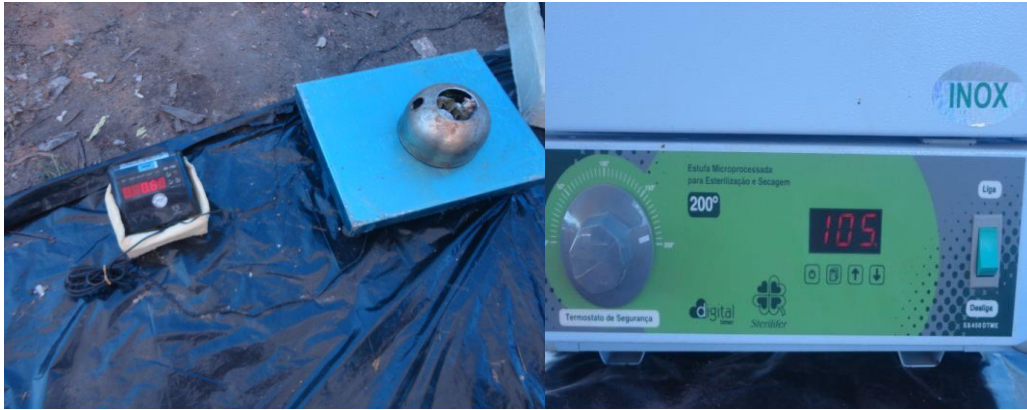
Figura 9 - Amostra de 2L de resíduos sendo pesada e posteriormente inserida em estufa que aquecerá até 105°C.
