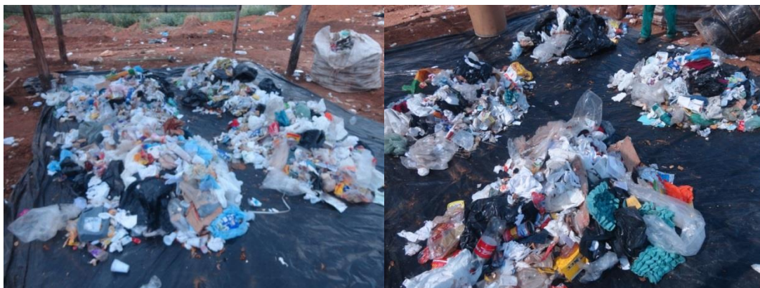
Figura 7 - Quarteamento e seleção de amostragem homogeneizada.
