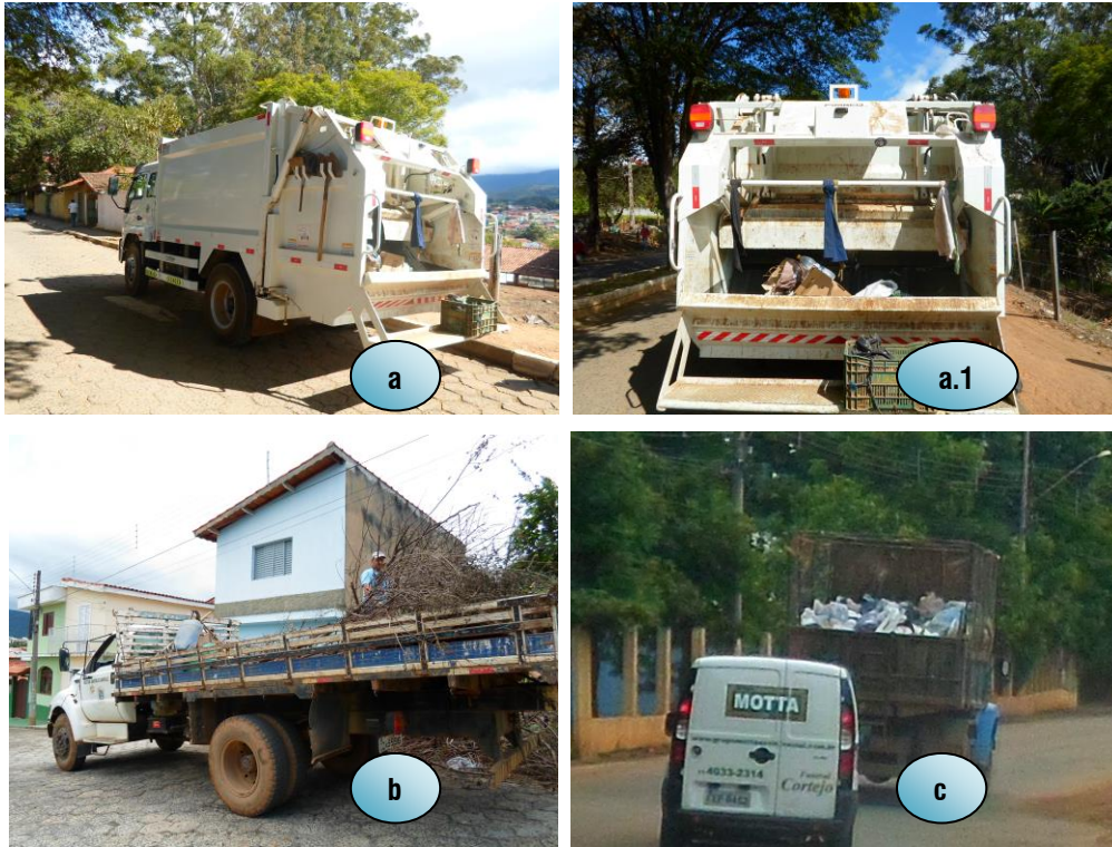
Figura 36 – Caminhões compactadores do município de Joanópolis: a e a.1) compactador; b) carroceria; c) caçamba.
