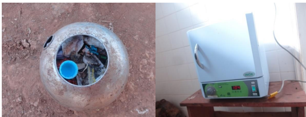
Figura 9 - Amostra de 2L de resíduos sendo pesada e posteriormente inserida em estufa que aquecerá até 105°C.
