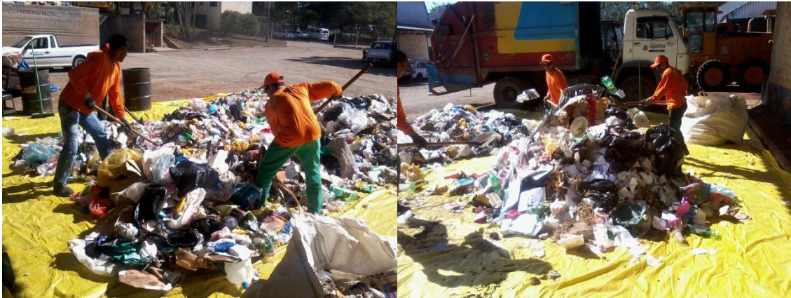
Figura 7 - Homogeneização dos resíduos.
