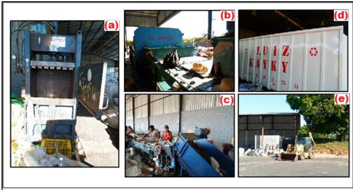
Figura 66 - Equipamentos da Central de Materiais Recicláveis: a) prensas hidráulicas; b) basculante com prensa interligada; c) esteira; d) caçambas basculantes; e) retroescavadeira.
