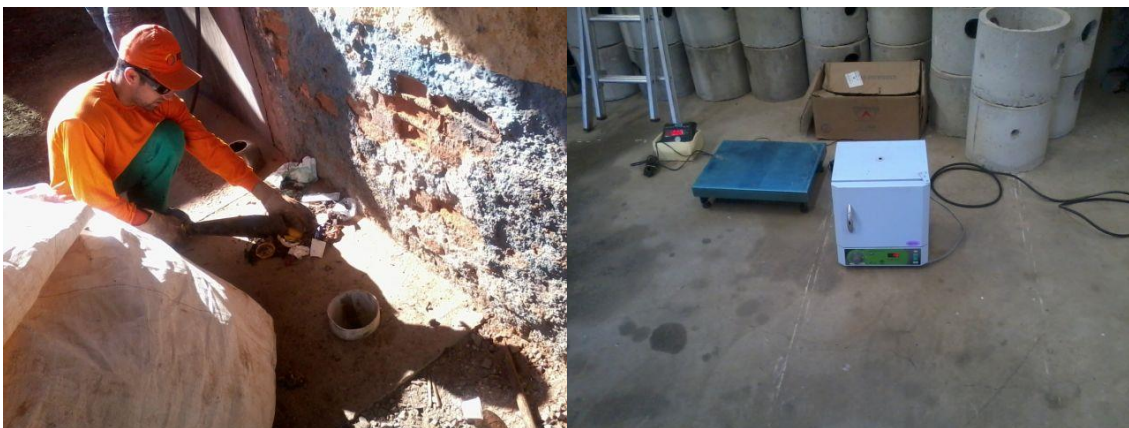
Figura 10 - Amostra de 2L de resíduos sendo selecionada e posteriormente inserida em estufa que aquecerá até 105°C.
