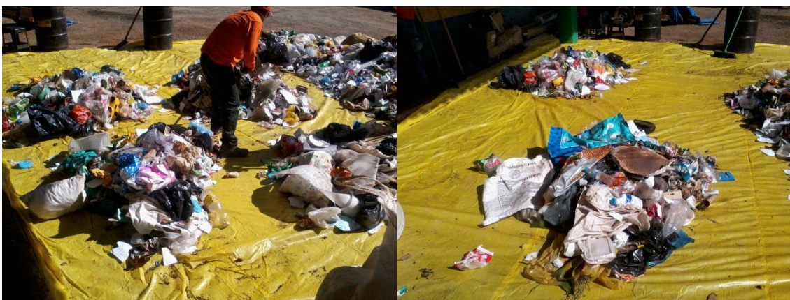
Figura 8 - Quarteamento e seleção de amostragem homogeneizada.
