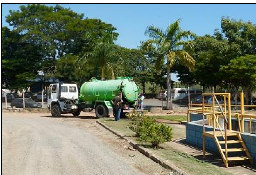
Figura 42 - Caminhão fossa despejando esgoto na EEE Central.
