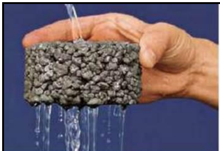
Figura 19 - Dispositivo de controle de escoamento – Pavimento poroso
