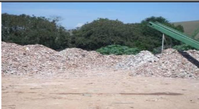
**Figura 87 - Vista do material inerte após a segregação por granulometria.**
