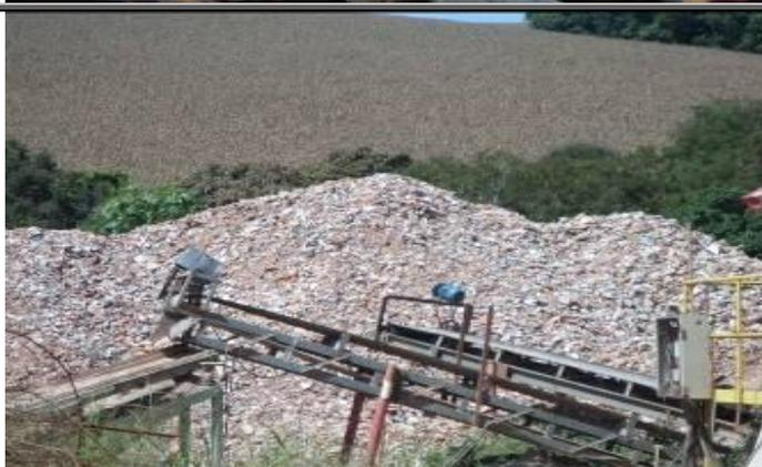
**Figura 86 - Vista do material inerte após a segregação por granulometria.**
