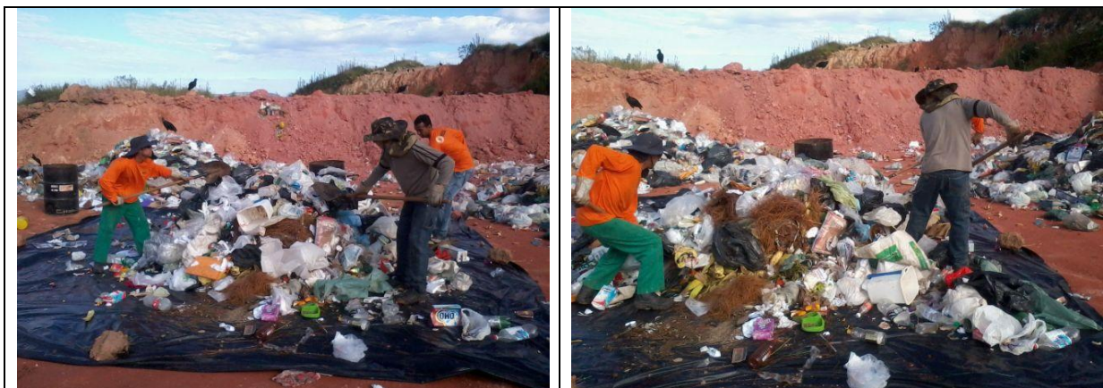
Figura 92 - Homogeneização dos resíduos
