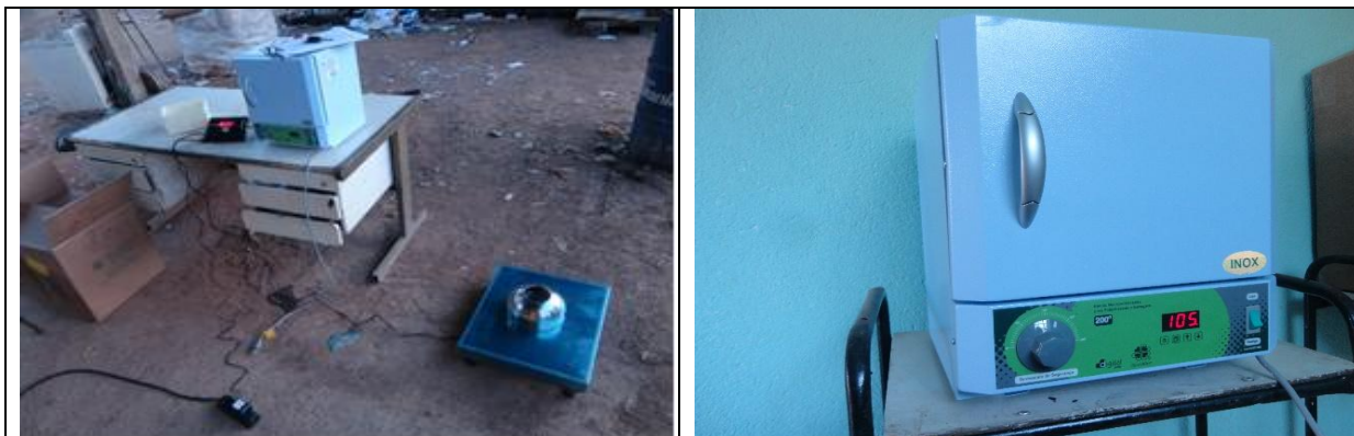
Figura 100 - Amostra de 2L de resíduos sendo pesada e posteriormente já inserida em estufa a 105°C
