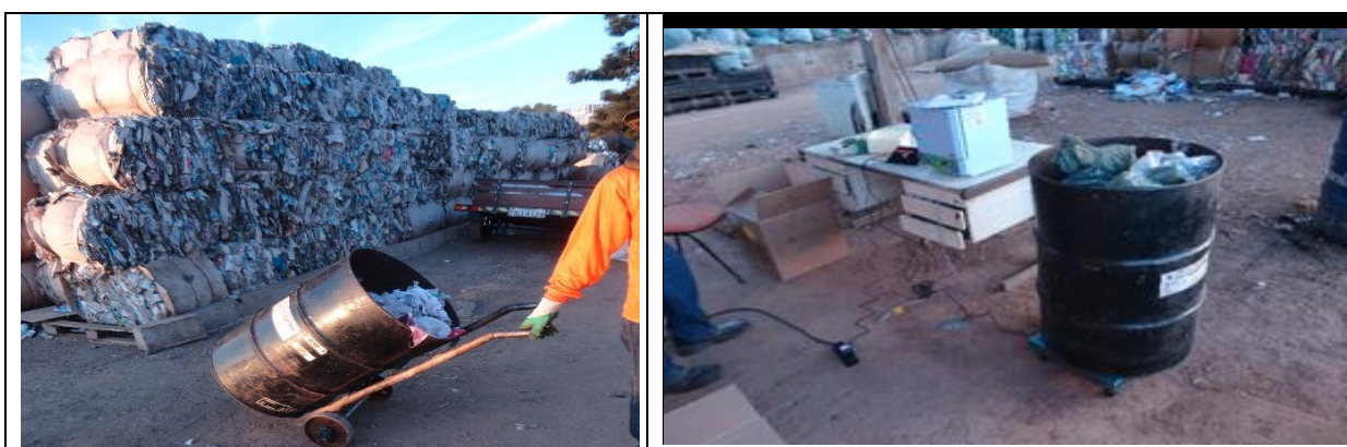
Figura 101 - Tambores com resíduos da amostra final sendo transportados até a balança e pesados
