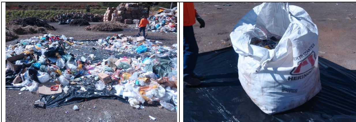
Figura 98 - Quarteamento e armazenamento da amostra final resultante de cada caminhão
