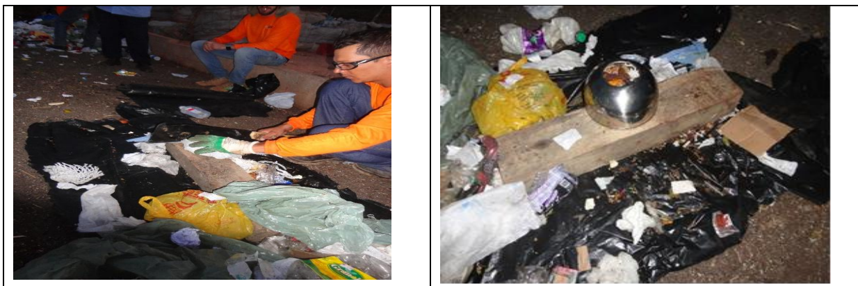
Figura 99 - Seleção da amostra de 2 litros para determinação do teor de umidade do RSU
