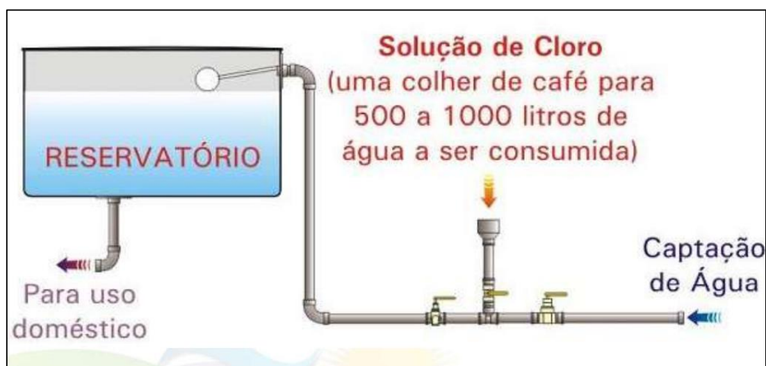
Figura 5 - Instalação de Clorador Embrapa na Rede de Captação de Água.
