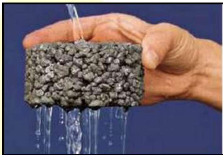
Figura 19 - Dispositivo de controle de escoamento – Pavimento poroso
