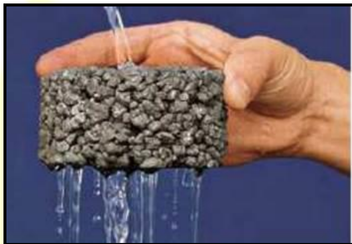
Figura 29 - Dispositivo de controle de escoamento – Pavimento poroso
