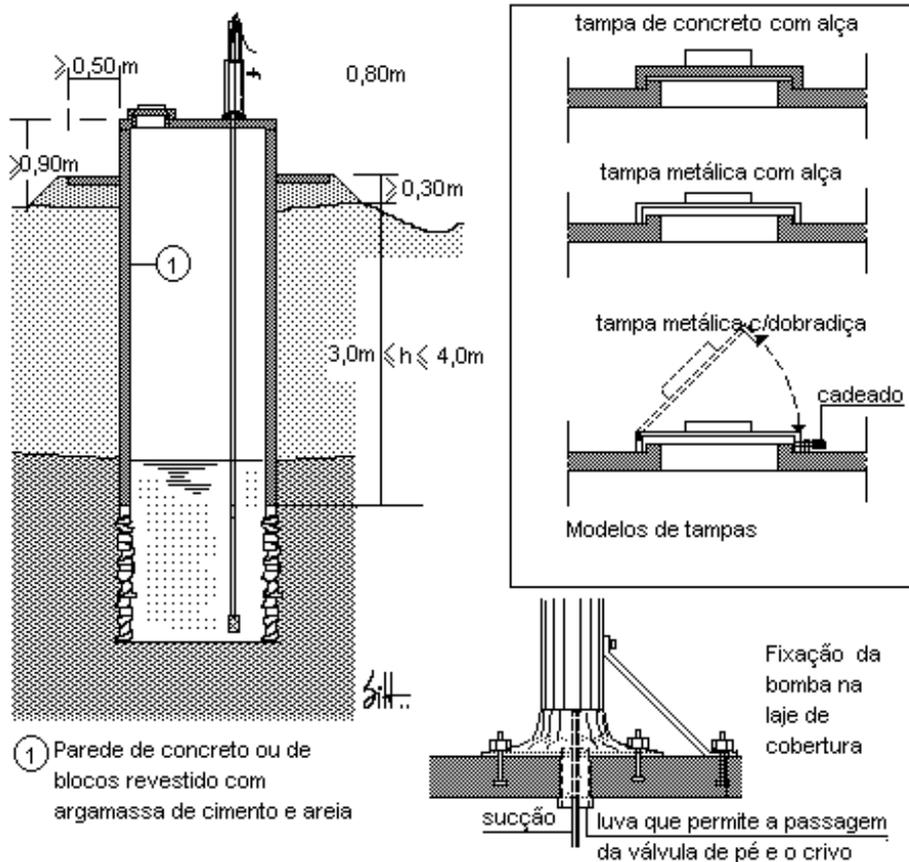
① Parede de concreto ou de blocos revestido com argamassa de cimento e areia
