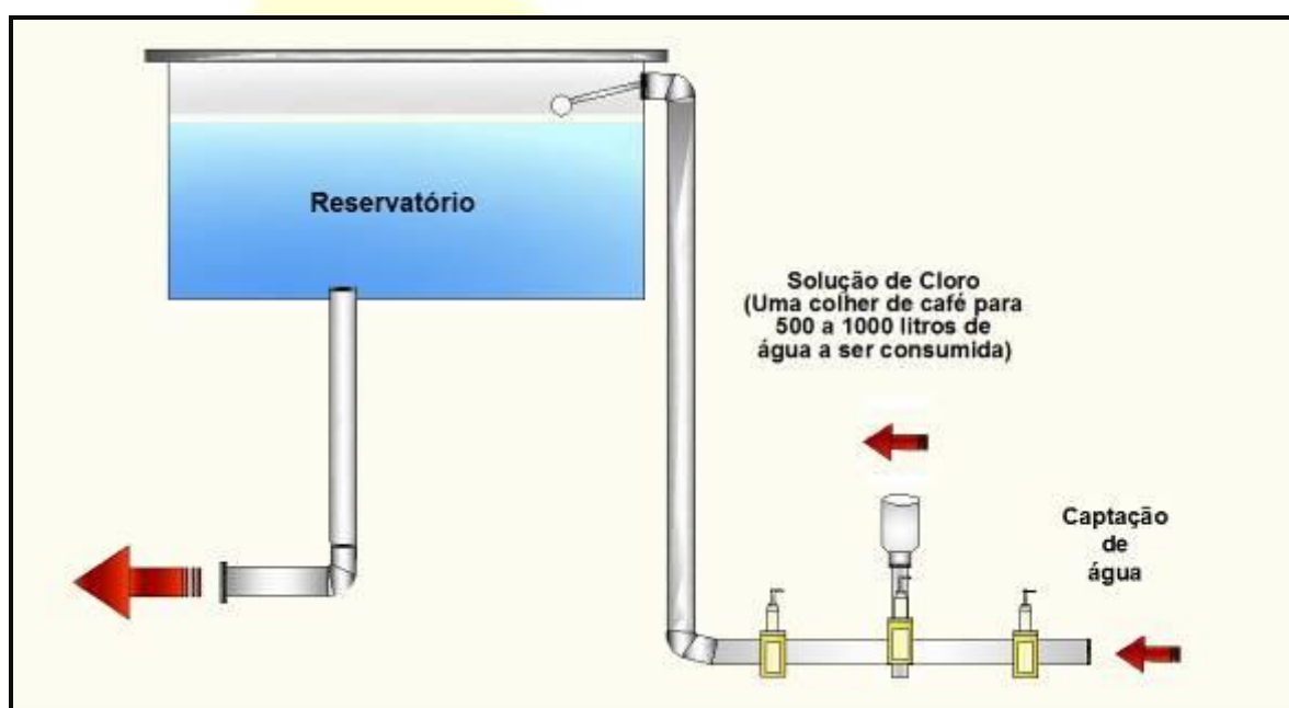
Figura 4 - Instalação de clorador EMBRAPA na rede de captação de água
