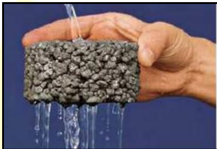
Figura 20 - Dispositivo de controle de escoamento – Pavimento poroso
