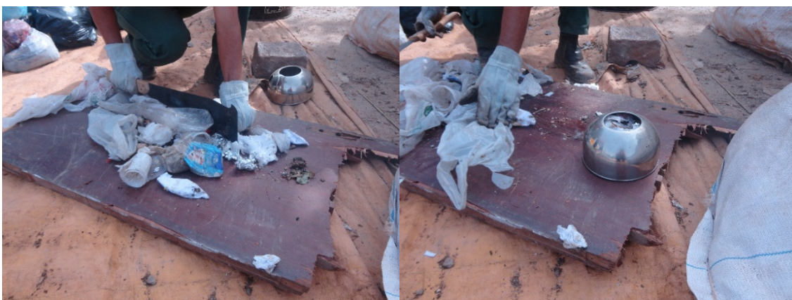
Figura 9 - Seleção da amostra de 2 litros para determinação do teor de umidade do RSU.
