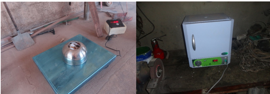
Figura 10 - Amostra de 2L de resíduos sendo pesada e posteriormente já inserida em estufa a 105°C.
