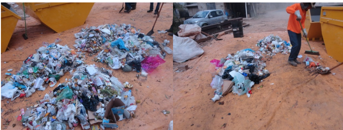
Figura 7 - Quarteamento e seleção de amostragem homogeneizada.
