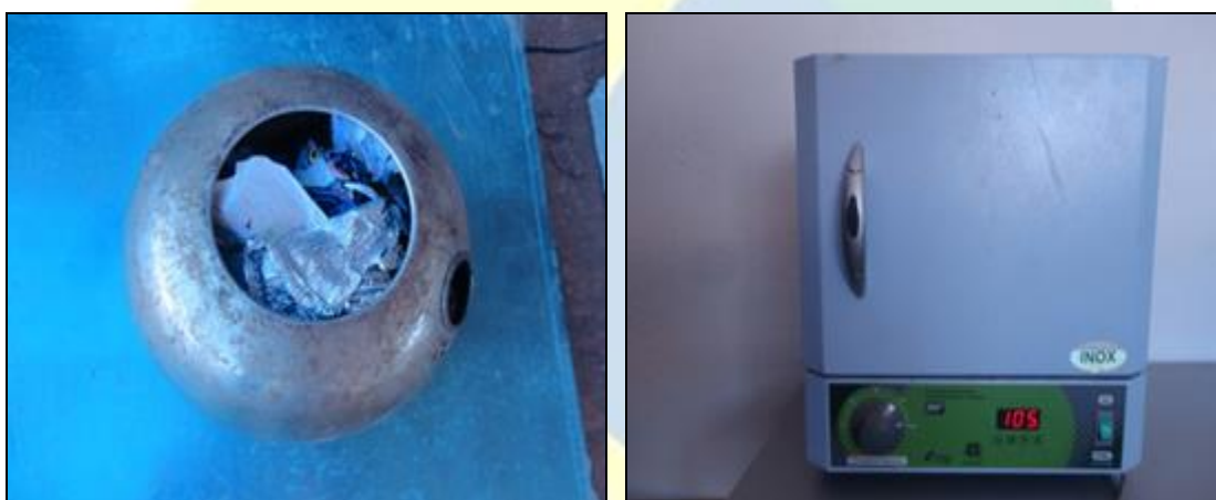
Figura 9. Amostra de 2L de resíduos sendo pesada e posteriormente já inserida em estufa a 105°C.
