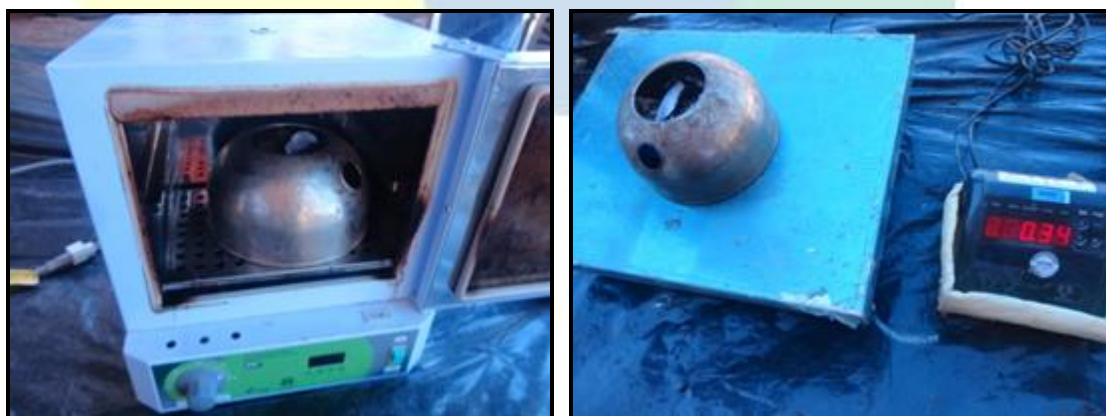
Figura 13. Retirada da amostra de 2L da estufa e pesagem da mesma
