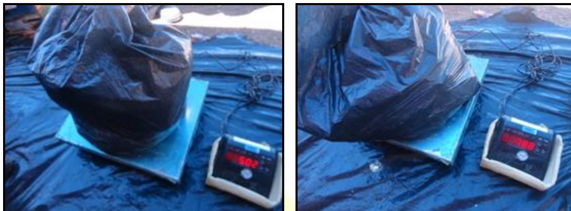
Figura 12. Pesagem dos resíduos segregados conforme quadro 1 e identificados através de etiquetas
