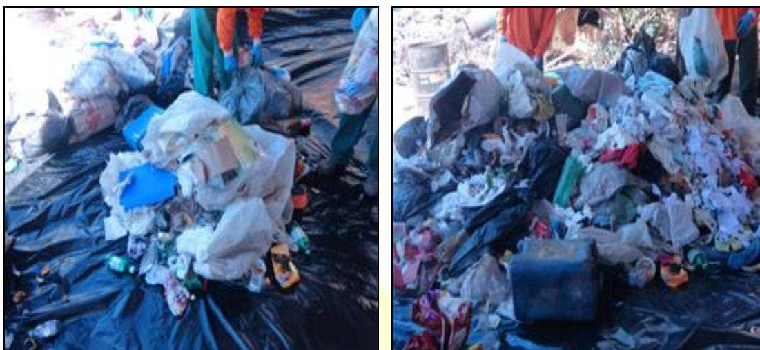
Figura 5. Disposição dos resíduos sobre a lona e retirada dos sacos e sacolas.
