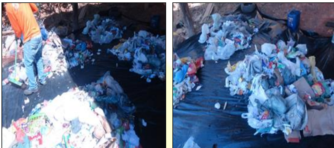
Figura 7. Quarteamento e armazenamento da amostra final resultante de cada caminhão.
