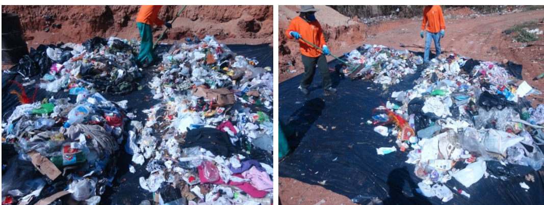
Figura 7 - Quarteamento e seleção de amostragem homogeneizada.
