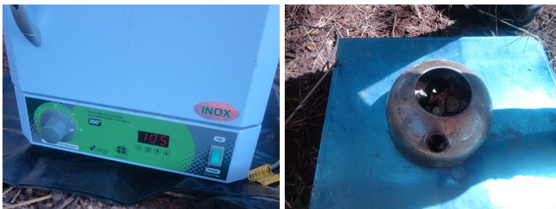
Figura 13 - Retirada do recipiente de 2 L da estufa e pesagem para determinação do teor de umidade.
