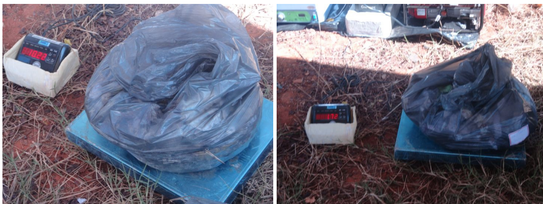
Figura 12 - Pesagem dos resíduos segregados conforme Tabela 1 e identificados através de etiquetas.
