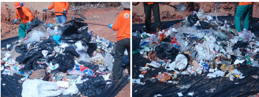
Figura 6 - Homogeneização dos resíduos.
