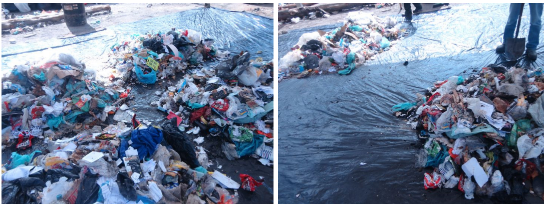
Figura 7 - Quarteamento e seleção de amostragem homogeneizada.
