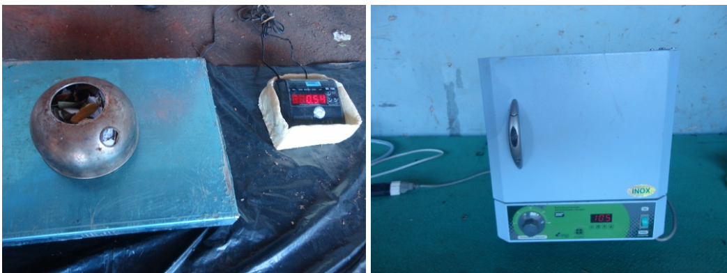
Figura 9 - Amostra de 2L de resíduos sendo pesada e posteriormente inserida em estufa que aquecerá até 105°C.
