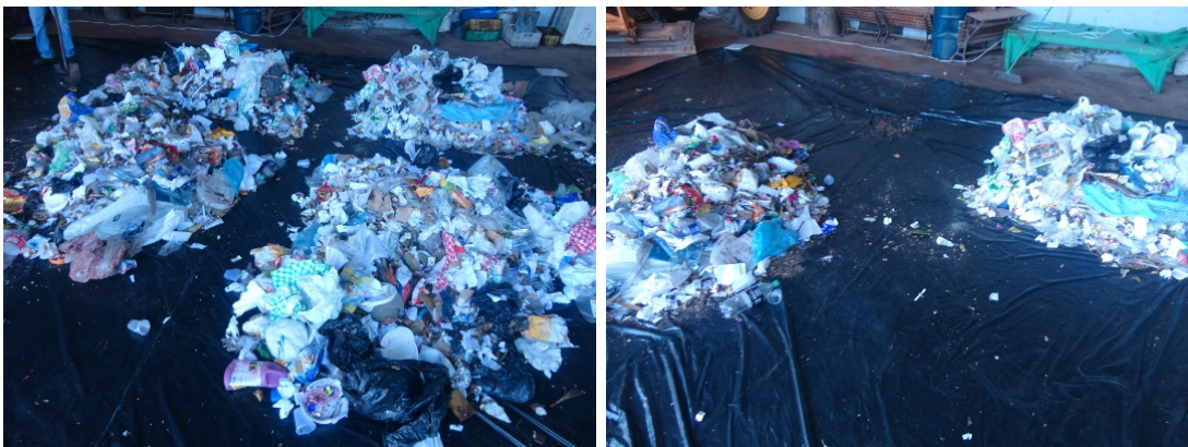
Figura 7 - Quarteamento e seleção de amostragem homogeneizada.
