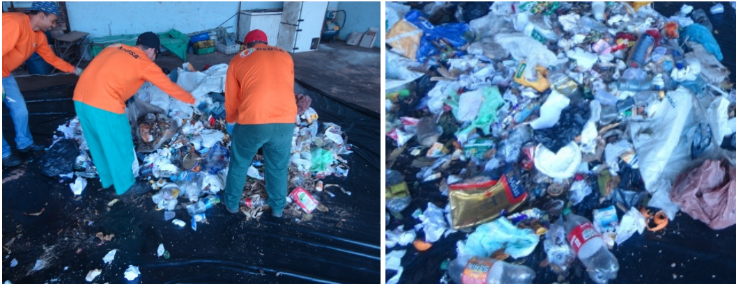
Figura 6 - Homogeneização dos resíduos.
