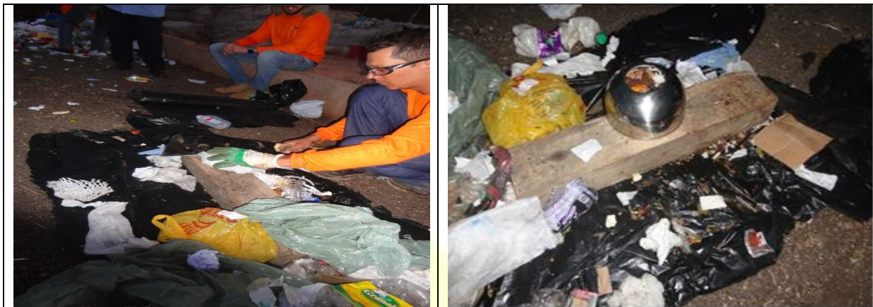
Figura 10 - Seleção da amostra de 2 litros para determinação do teor de umidade do RSU
