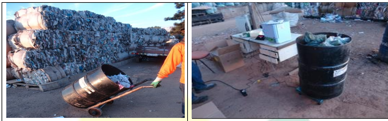
Figura 12 - Tambores com resíduos da amostra final sendo transportados até a balança e pesados
