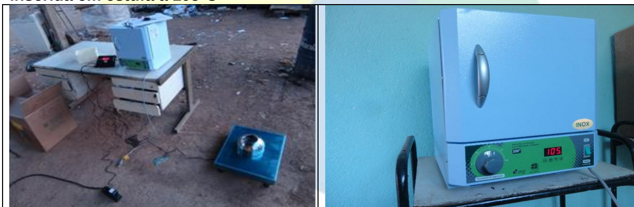
Figura 11 - Amostra de 2L de resíduos sendo pesada e posteriormente já inserida em estufa a 105°C
