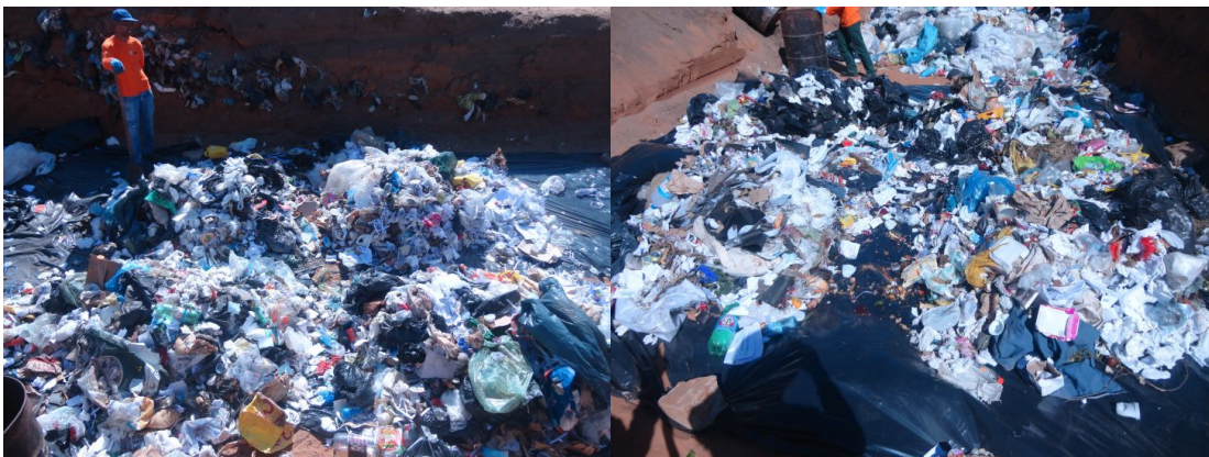
Figura 8 - Quarteamento e seleção de amostragem homogeneizada.
