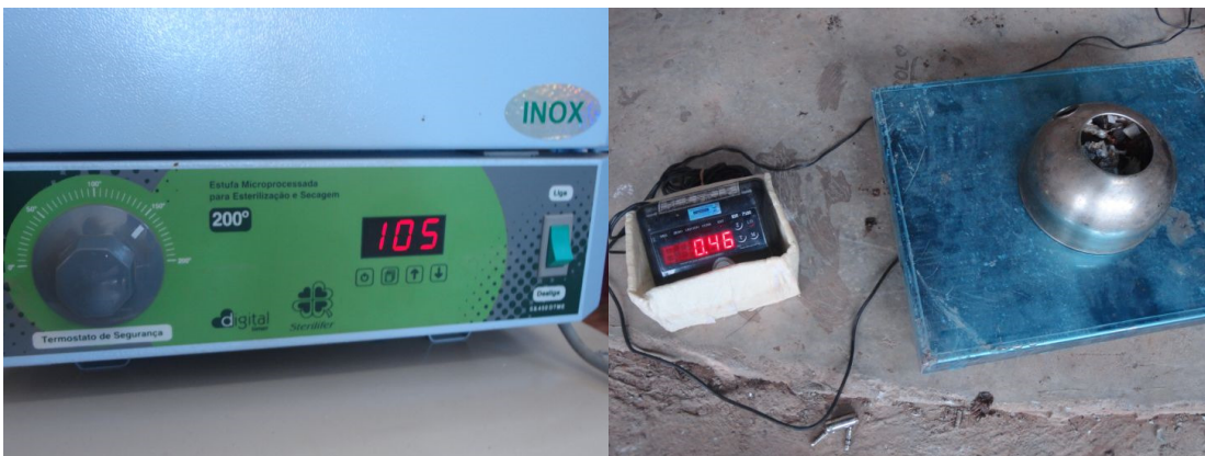
Figura 14 - Retirada do recipiente de 2 L da estufa e pesagem para determinação do teor de umidade.
