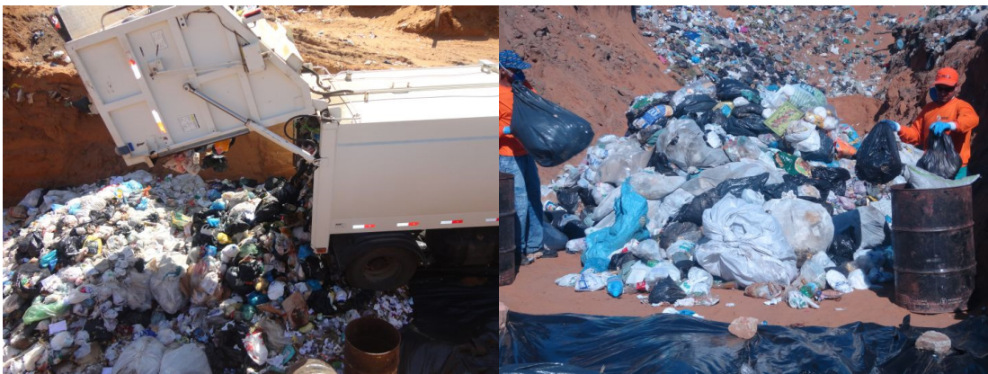
Figura 4 - Coleta de resíduos realizada pelos caminhões compactadores e seleção de amostra inicial.
