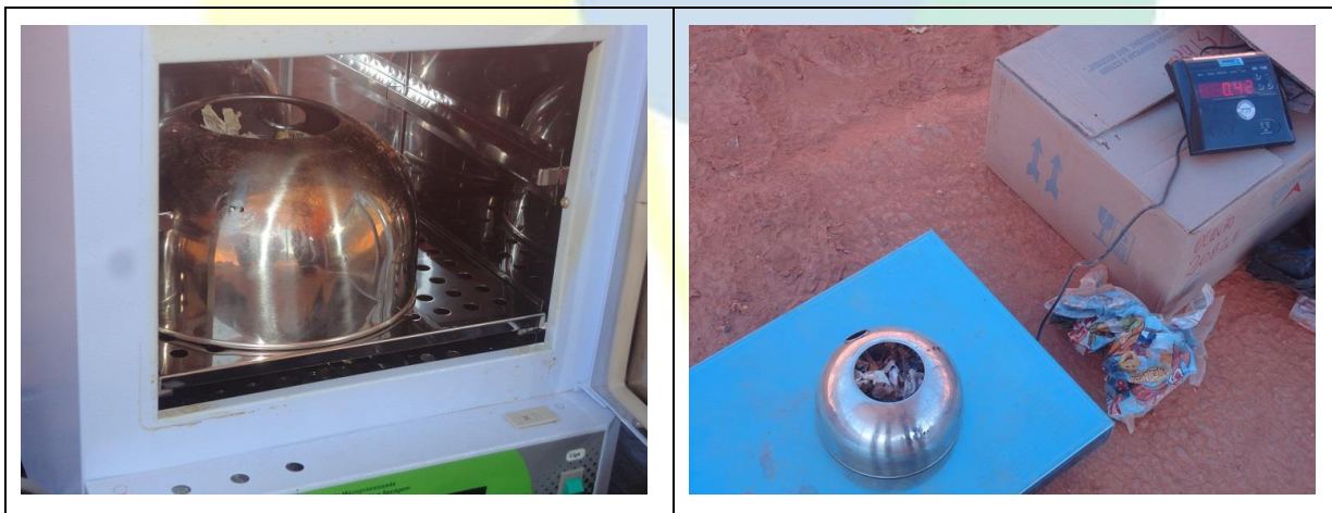
Figura 18 - Retirada da amostra de 2L da estufa e pesagem da mesma
