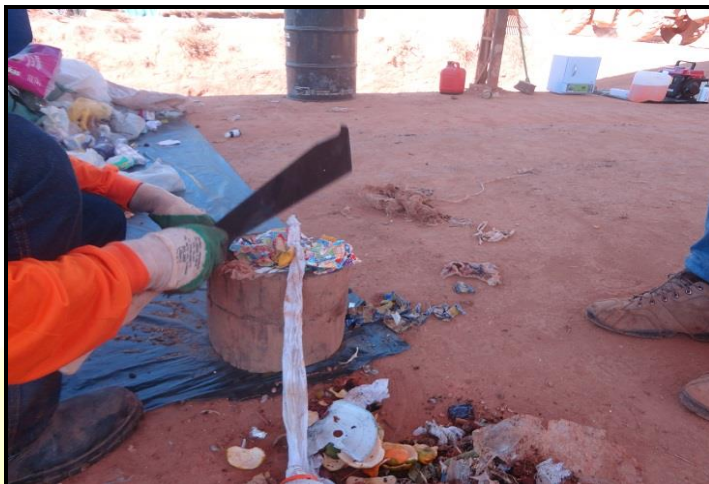
Figura 13 - Seleção da amostra de 2 litros para determinação do teor de umidade do RSU.
