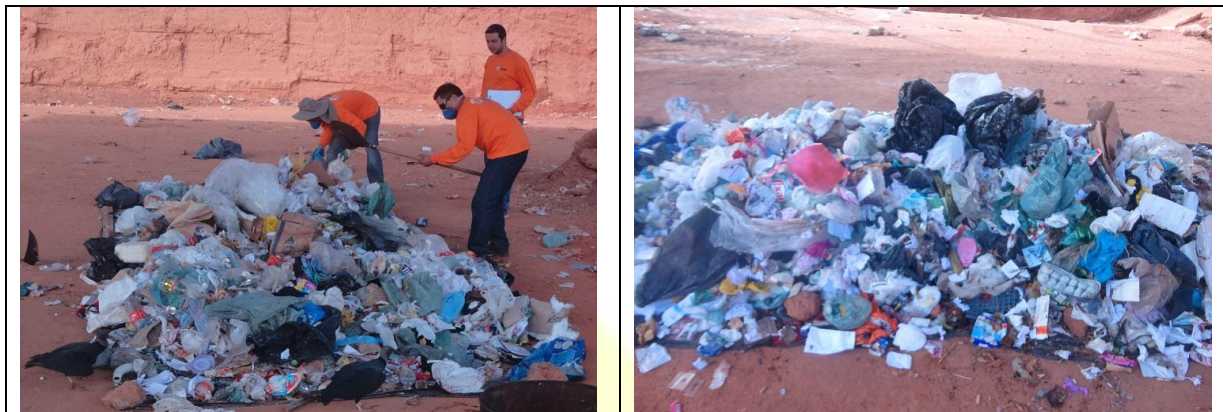
Figura 10 - Disposição dos resíduos sobre a lona e retirada dos sacos e sacolas.
