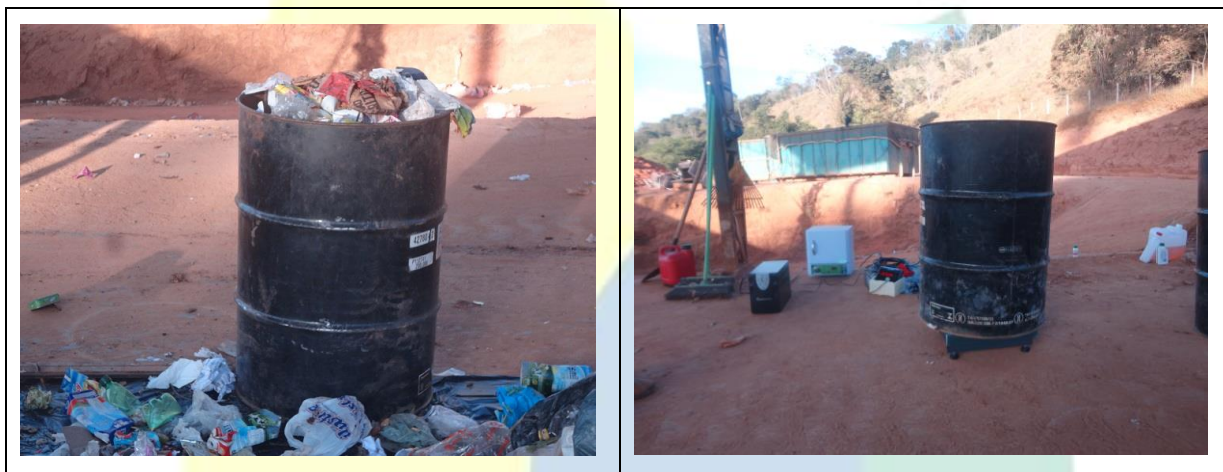
Figura 15 - Tambores com resíduos da amostra final sendo transportados até a balança e pesados
