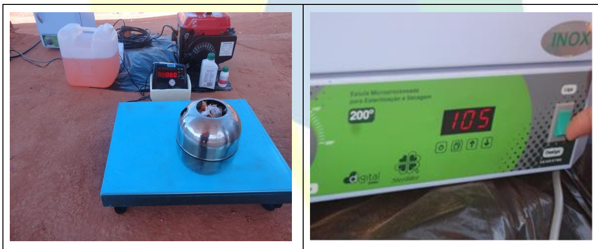
Figura 14 - Amostra de 2L de resíduos sendo pesada e posteriormente já inserida em estufa a 105°C.
