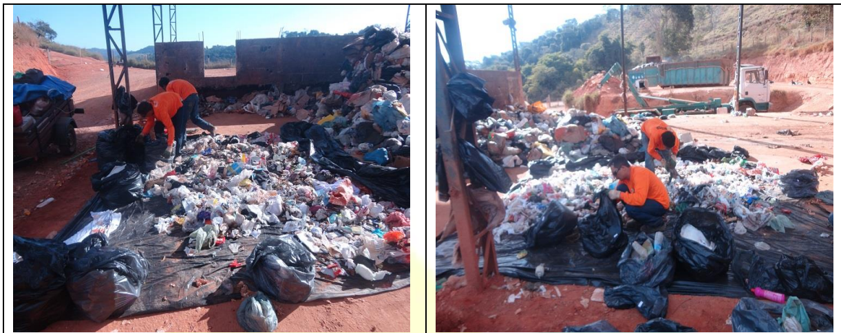
Figura 16 - Segregação e armazenamento de cada tipo de resíduo.
