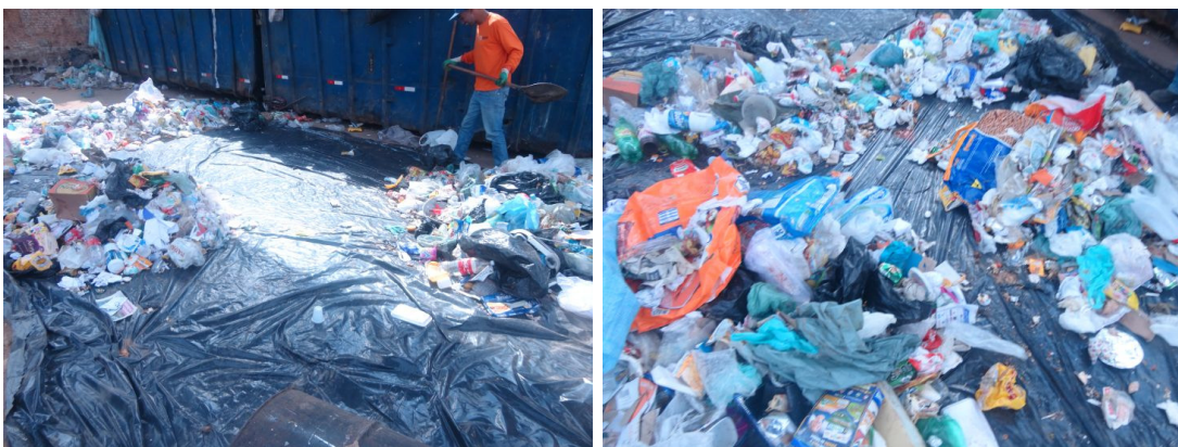
Figura 7 - Quarteamento e seleção de amostragem homogeneizada.
