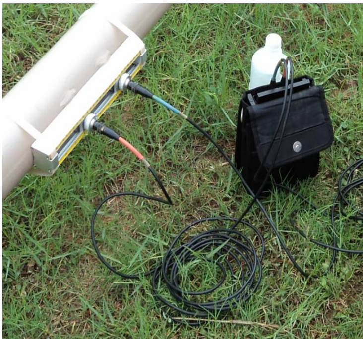
Figura 3.5. Ilustração da conexão entre os transdutores e a Unidade Eletrônica
