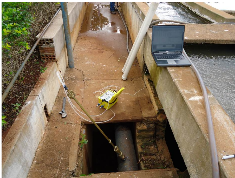
Figura 06. Vista durante uma medição através da pitometria
