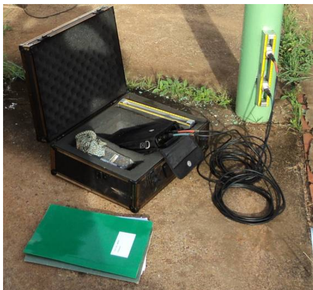
Figura 1.1. Ilustração do Medidor Ultrassônico instalado
