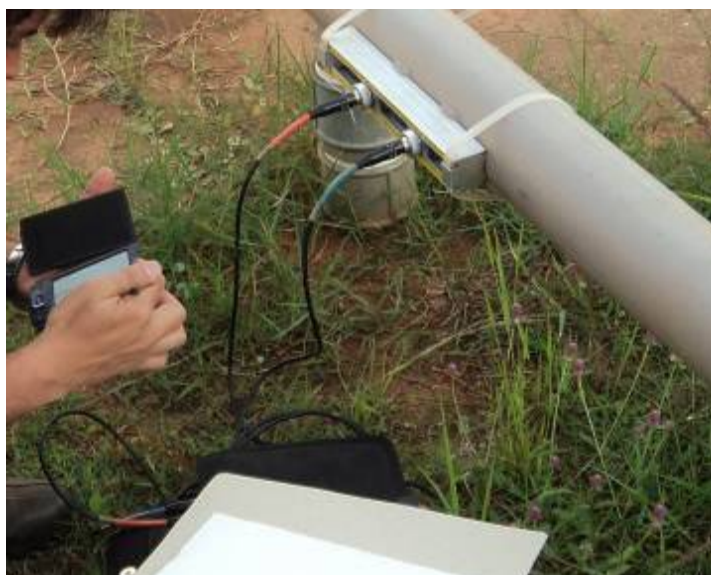
Figura 1.2. Ilustração da comunicação entre o Palm e Unidade Eletrônica
