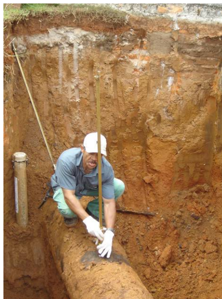
Figura 3.17. Medição do diâmetro real da adutora com o equipamento Calibre
