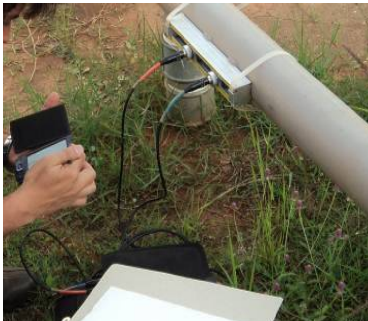
Figura 3.2. Ilustração da comunicação entre o Palm e Unidade Eletrônica
