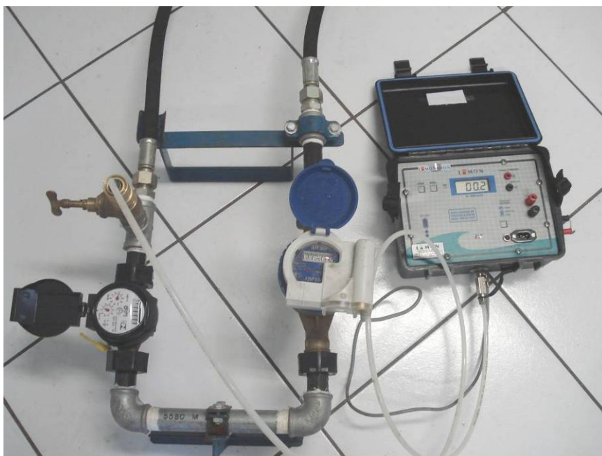
Figura 7.1. Equipamento data-logger de pressão que será utilizado para medir pressão no sistema de abastecimento do município de Analândia
