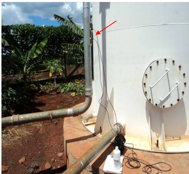
Figura 3.3. Ilustração da posição de escolha para instalação do medidor Ultrassônico (tubulação vertical)
