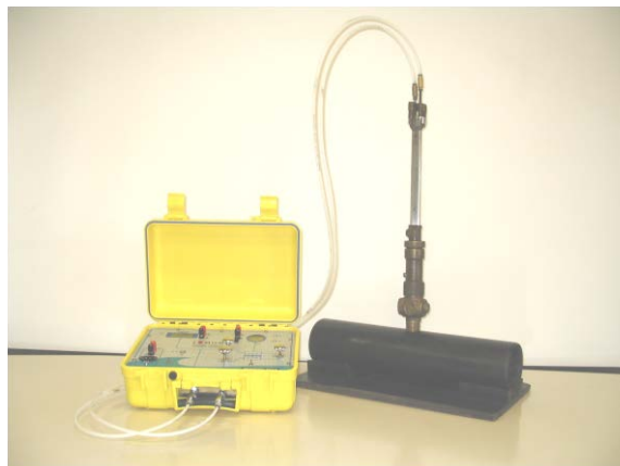
Figura 3.19. Tubo Pitot inserido em uma tubulação e conectado a um equipamento que contém um sensor de diferencial de pressão
