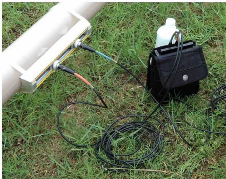
Figura 1.5. Ilustração da conexão entre os transdutores e a Unidade Eletrônica
