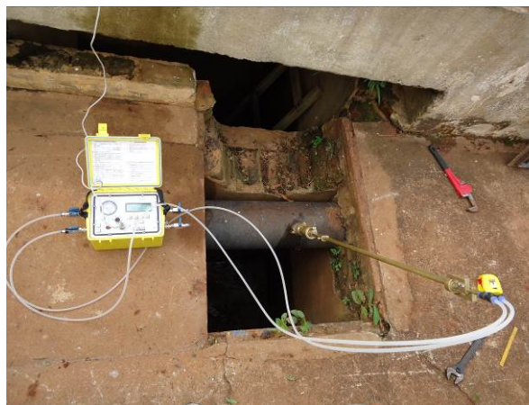
Figura 1.14. Vista do Pitot, mangueiras e sensor diferencial de pressão
