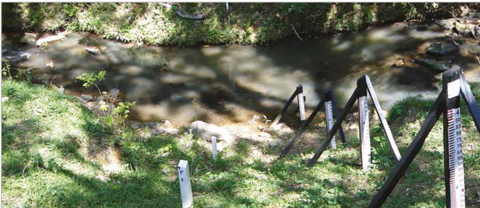
Réguas de medição de vazão
