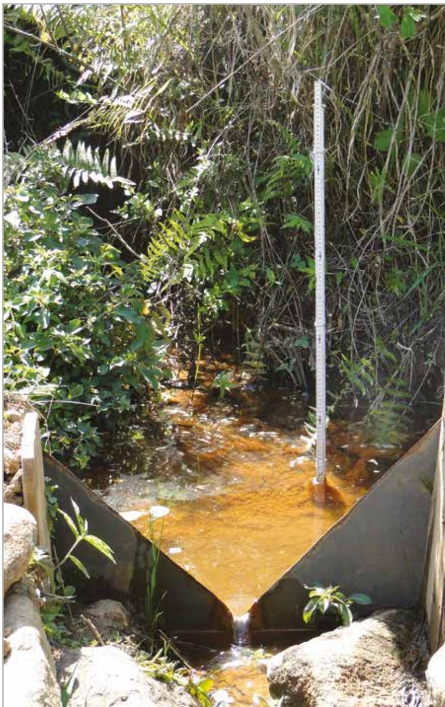
O monitoramento de recursos hídricos no Projeto Conservador das Águas está sendo realizado pela Companhia de Pesquisa de Recursos Minerais (CPRM) através do convênio com a Agência Nacional de Águas (ANA) com apoio da Prefeitura de Extrema, foram instaladas duas réguas de medição de vazão e cinco pluviômetros as leituras são feitas diariamente.
